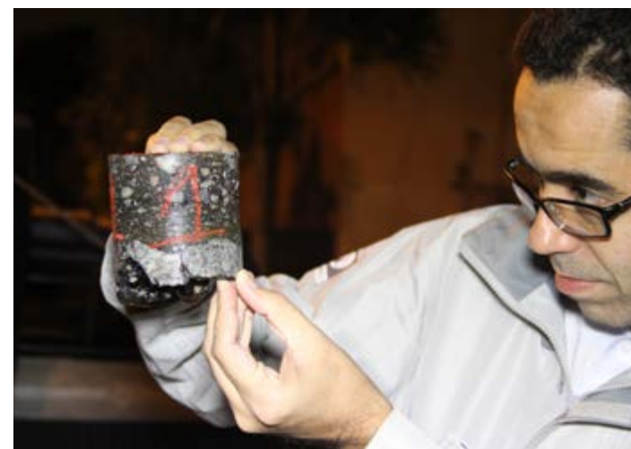
Ensaio tecnológico para verificar a correta composição dos pavimentos de ruas e avenidas.
