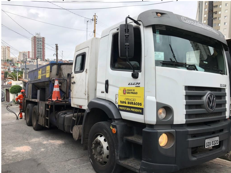
Figura 21 – Veículo placa GDX-9320 utilizado para aplicação do concreto asfáltico
