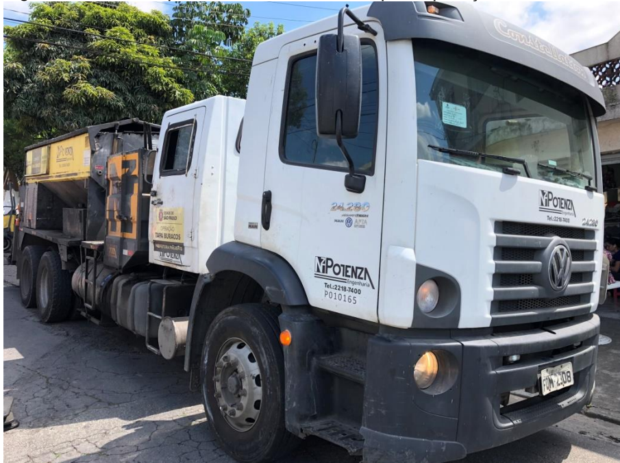
Figura 27 – Veículo placa FOM-2308 utilizado para aplicação do concreto asfáltico
