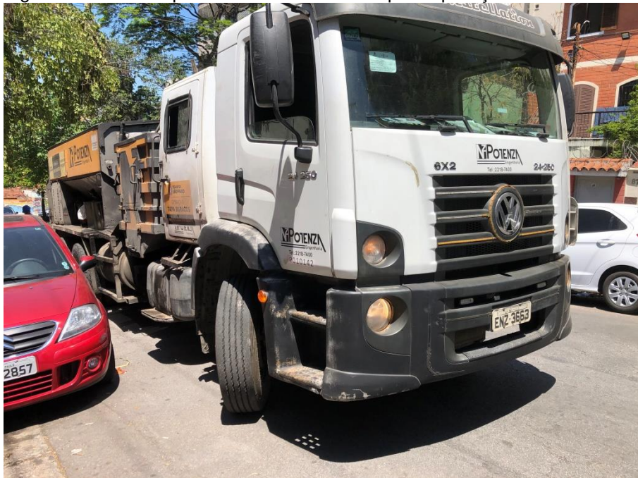
Figura 11 – Veículo placa ENZ-3663 utilizado para aplicação do concreto asfáltico
