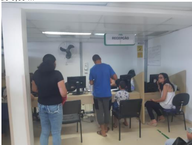
Figura 35 - Balcão do Ambulatório com altura adequada de 0,69 m
