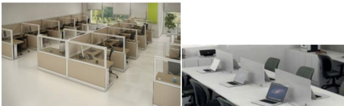
Figura 2 – Divisória tipo painel, à esquerda, e painel divisório, à direita
