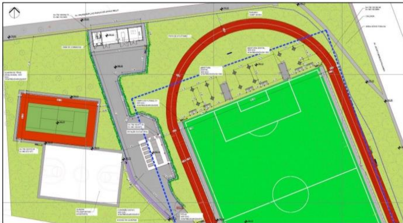
Figura 4 – Implantação parcial das obras sobre a laje do piscinão: casa de comando e estação elevatória
