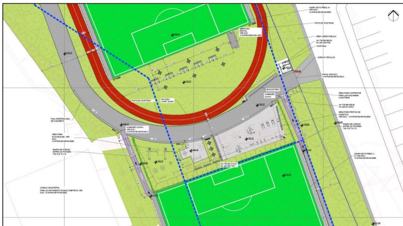
Figura 5 – Implantação parcial das obras sobre a laje do piscinão
