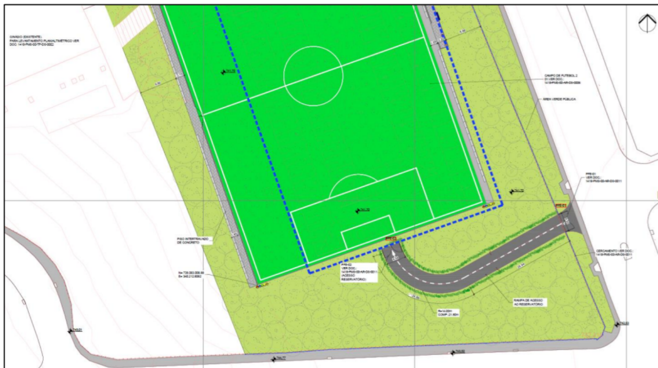
Figura 6 – Implantação parcial das obras sobre a laje do piscinão: rampa de acesso ao interior do piscinão
